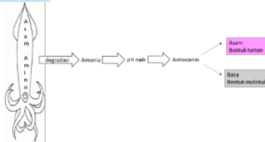
Gambar 2 Mekanisme sensor kesegaran
