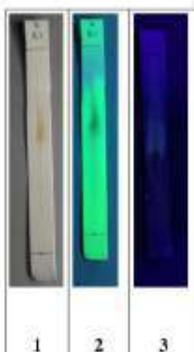
Gambar 3. Hasil Uji KLT diamati menggunakan fase gerak menggunakan metanol (5) : kloroform(2) : asasetat glasial (1 tetes)
