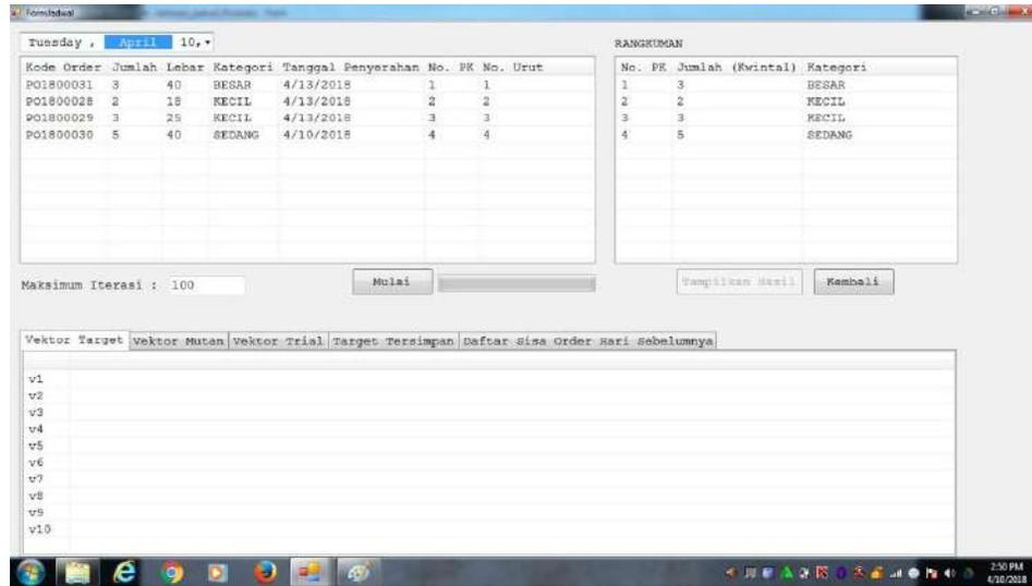
Setting iterasi dapat dilakukan, apabila tidak default iterasi 100 dan penekanan tombol mulai akan menjalankan algoritma Differential Evolution sehingga akan mengisi vector target, vector mutan, vektro trial, target tersimpan dan daftar sisa order hari sebelumnya.
