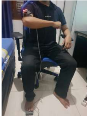
Gambar 2. Pemasangan prototipe pada lengan atas dan footswitch di kaki kanan untuk fungsi klik.
