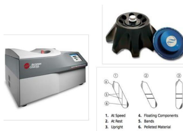
Gambar 3. Sentrifus ultra dan rotor tipe sudut tetap (MLA-50) yang digunakan dalam praktikum biokimia, Prodi Kimia, Universitas Ma Chung.
