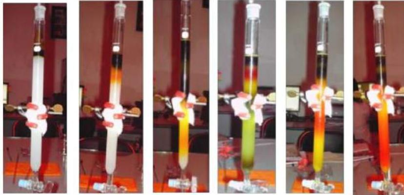
Gambar 2. Pemisahan ekstrak pigmen fotosintesis yang terjadi pada kromatografi kolom. Tampak pita-pita berwarna terpisah akibat interaksi dengan resin pada kolom
