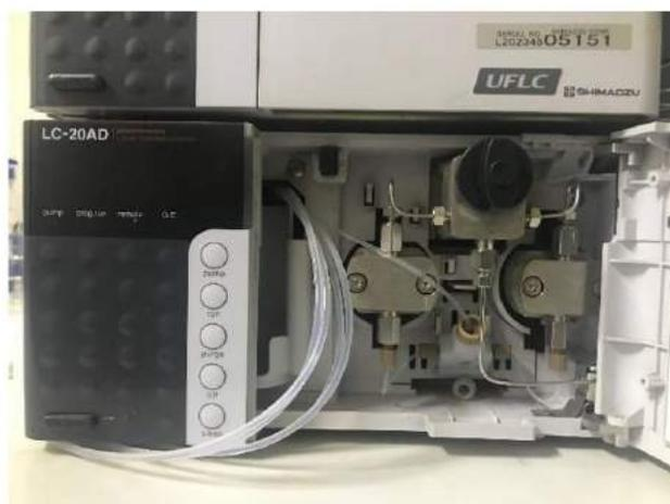
Gambar 8. Pompa KCKT dari Shimadzu seri LC-20AD
