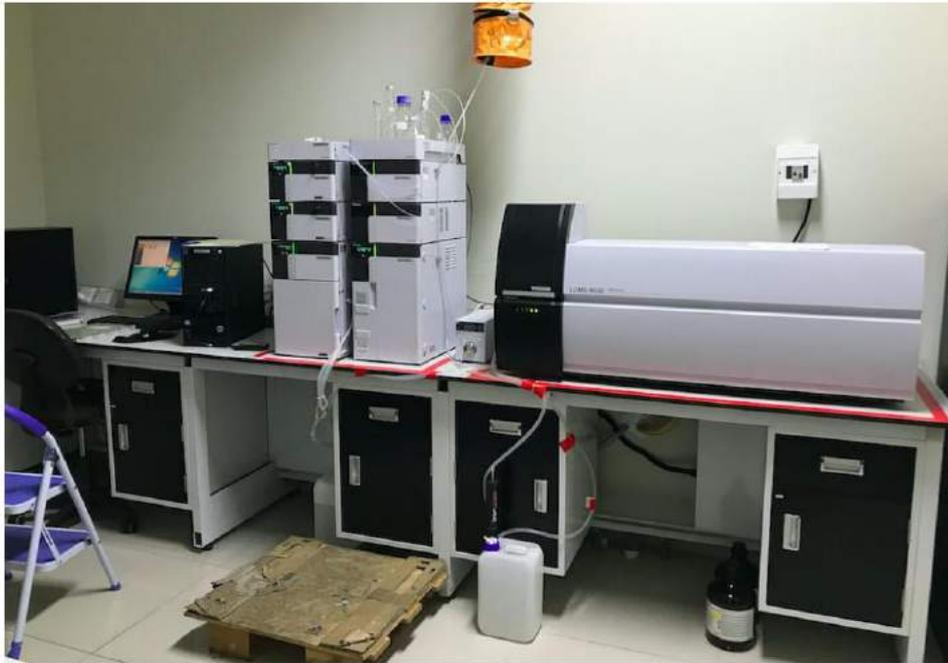
Gambar 14. KCKT yang terkoneksi dengan spektroskopi massa (HPLC-ESI-MS/MS) dengan tipe LCMS 8030 dari Shimadzu yang digunakan mahasiswa dalam praktikum ini.
