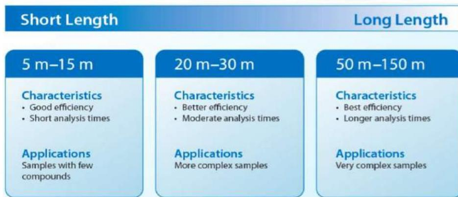
Gambar 27. Diagram perbandingan panjang kolom dimana dapat meningkatkan resolusi tapi juga meningkatkan biaya dan waktu analisis.
