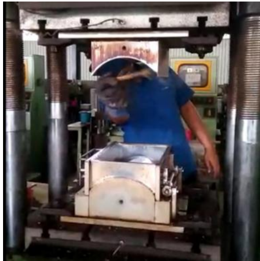
Gambar 6. Proses hidrolis menggunakan matras untuk mencetak kampas
