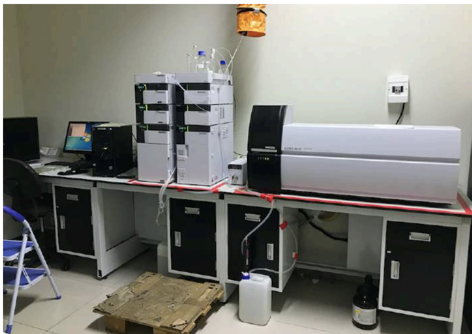
Gambar 16. KCKT yang terkoneksi dengan spektroskopi massa (HPLC-ESI-MS/MS) dengan tipe LCMS-8030 dari Shimadzu yang digunakan mahasiswa Program Studi Kimia, Universitas Ma Chung, Malang.
