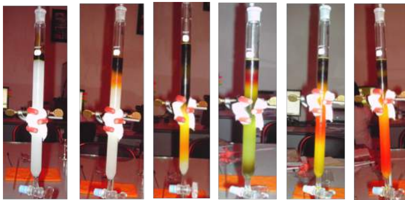
Gambar 4. Pemisahan ekstrak pigmen fotosintesis yang terjadi pada kromatografi kolom. Tampak pita-pita berwarna terpisah akibat interaksi dengan resin pada kolom
